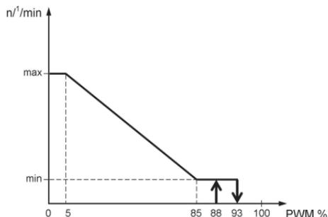
Le pompe collegate sulle uscite PWM E e/o PWM W funzionano secondo lo standard "PWM1", mediante la logica di riscaldamento, anche detta invertita. Con il segnale PWM generato al minimo valore (0%) la pompa gira alla massima velocità, mentre con il segnale PWM generato al massimo valore (100%) la pompa gira alla minima velocità. Ovviamente
