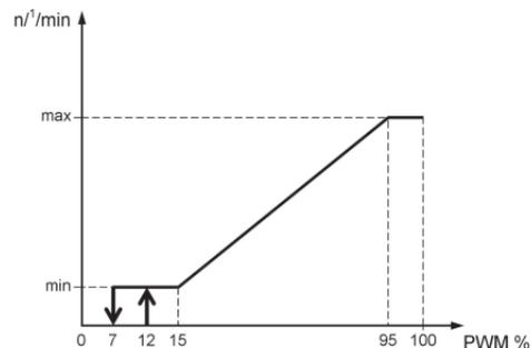
Le pompe collegate sulle uscite PWM E e/o PWM W funzionano secondo lo standard "PWM2", mediante la logica solare, anche detta normale.
