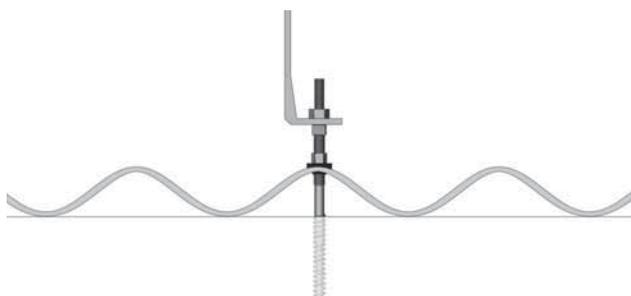
Sezione trasversale del fissaggio con vite prigioniera. Fare in modo che la guarnizione venga serrata adeguatamente con l'aiuto del dado, senza danneggiare la copertura. Evitare che la filettatura della vite prigioniera ostruisca l'asola verticale della squadretta.
