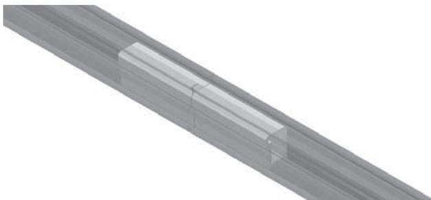
Ora aggiungere la seconda guida infilandola con forza e andando a inglobare la connessione che non sarà più visibile, quando le due guide saranno a contatto. La connessione è così completata.
