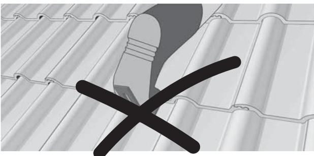
Attenzione! Non utilizzare le staffe fissate come punti di appoggio altrimenti si rischia di danneggiare le tegole sottostanti a causa del carico eccessivo!
