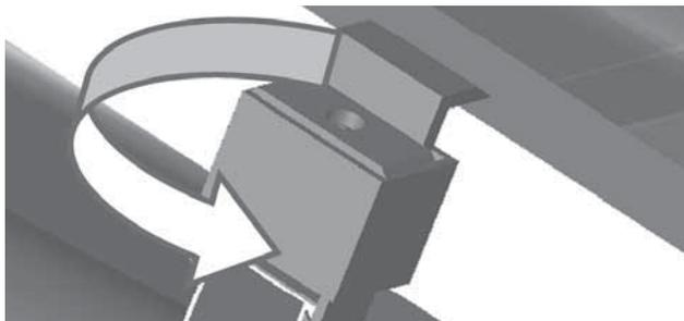
Fissare i moduli con i morsetti di supporto come mostrato nella figura: inserire lateralmente il morsetto di supporto finale nella guida e farlo scivolare sul lato del modulo. I morsetti finali vengono adattati allo spessore del telaio del modulo tramite rotazione antioraria della chiave a brugola e poi fissati (coppia di torsione 9-10 Nm).
